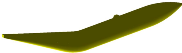
Рис. 2. Пример теоретического контура изделия (типа подвесного топливного бака)
