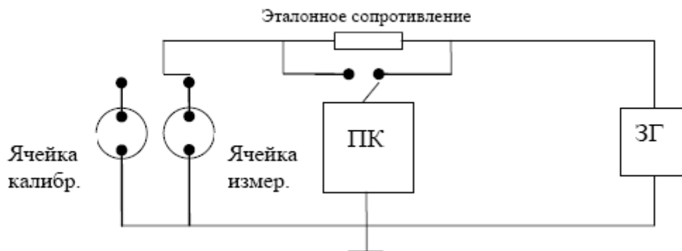
Рисунок 2. Схема электрических цепей установки для измерения электропроводности шлаков:
