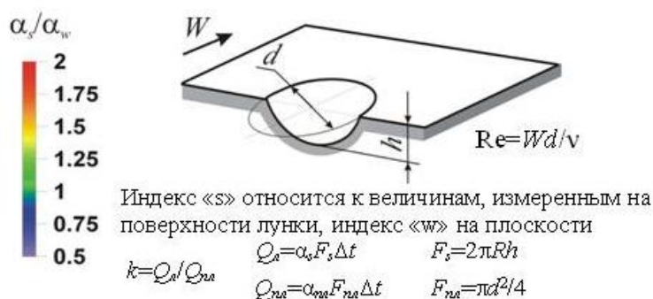
Рис. 2. Местные значения коэффициента теплоотдачи в лунке (отнесенные к значениям для пластины)
