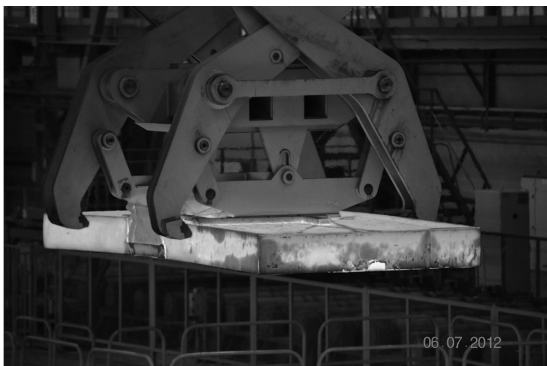
Рис. 2. Экспериментальный сляб с АРТ после выдачи из печи
