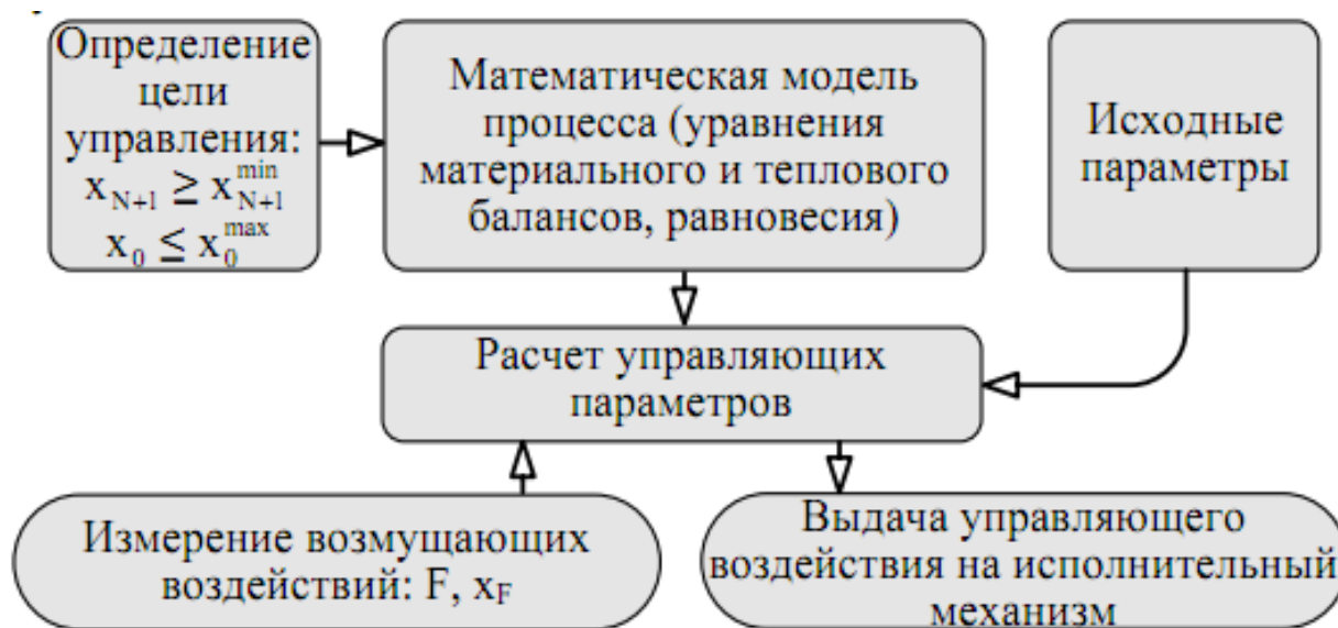
Рис. 3. Система управления процессом ректификации
